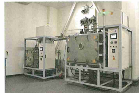
(写真上)西光エンジニアリング開発の量産型乾燥機。(写真中)日本で初めて実用化したマイクロ波減圧乾燥機。(写真右)同機で乾燥させたドライフルーツ
